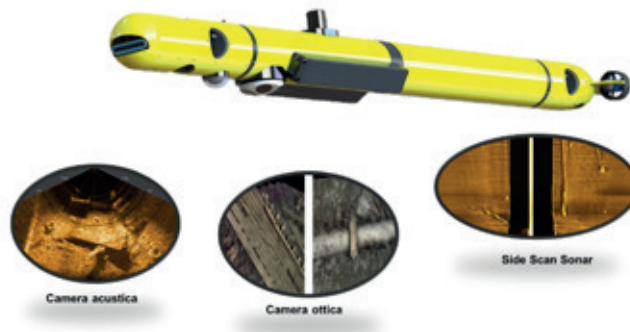
Figura 1 - Render del veicolo autonomo X300 progettato per il PNRM PACMAN. In particolare sono resi evidenti i sensori di cui è dotato il veicolo per fare detezione, classifica e riconoscimento delle potenziali minacce subacquee.
