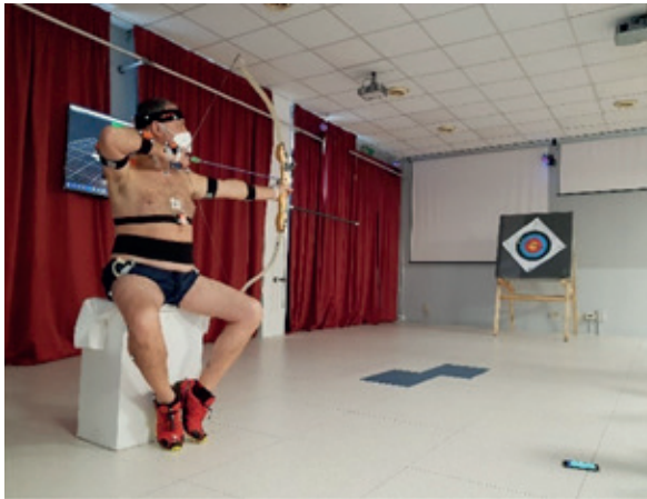
Figura 4 - Tiro con l'arco - Acquisizione stereofotogrammetrica del gesto sportivo.
