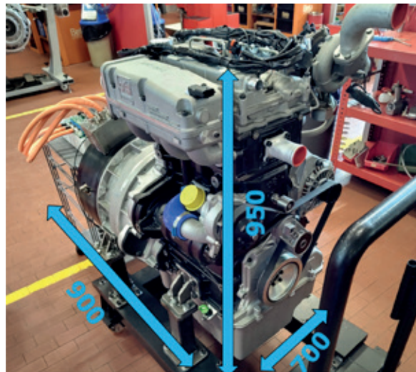
Figura 4 - Dimensioni complessive del gruppo ibrido 2CHDP.
