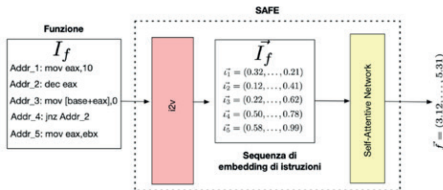
Figura 2 - Architettura di alto livello della rete neurale SAFE. La rete prende in ingresso una funzione in codice assembly e la trasforma in un vettore numerico.
