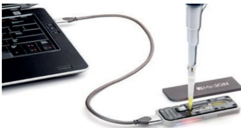
Figura 4 - Sequenziamento di terza generazione. In figura viene enfatizzato l'esiguo ingombro spaziale di un chip ed un computer portatile sufficienti per eseguire un sequenziamento mediante la tecnologia dei "nanopori" e l'analisi in situ in tempo reale.
