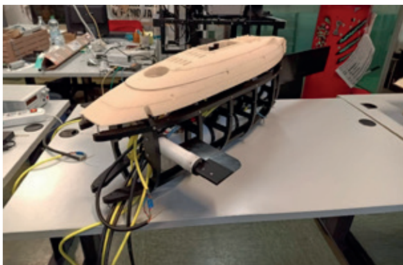
Figura 4 - Il prototipo PERSICO durante la fase di assemblaggio.
