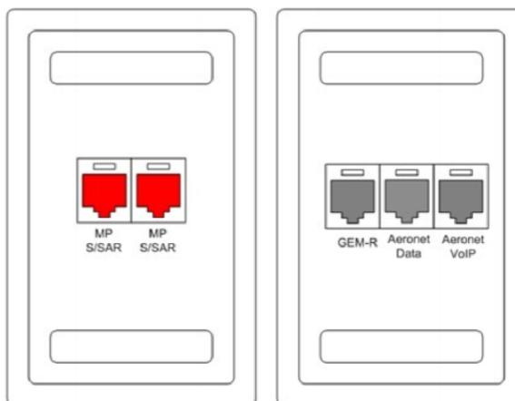
Figura 3 - Esempio di etichettatura per le postazioni di lavoro asservite al sistema ALIS.
