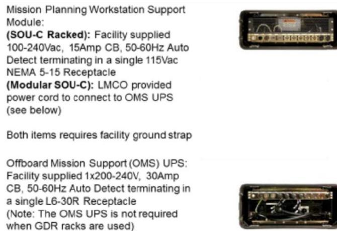
Figura 10 - Requisiti elettrici per l'alimentazione dei moduli periferici MPWs SM e OMS UPS.
