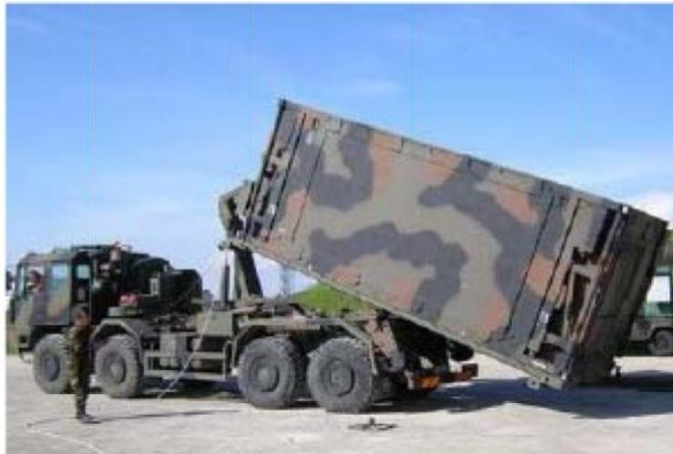
Figura 14 - Esempio di caricamento shelter 20ft su veicolo 8x8.
