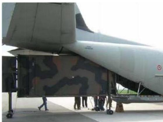
Figura 13 - Esempio di sistema per il caricamento su velivolo C130J senza K-Loader.
