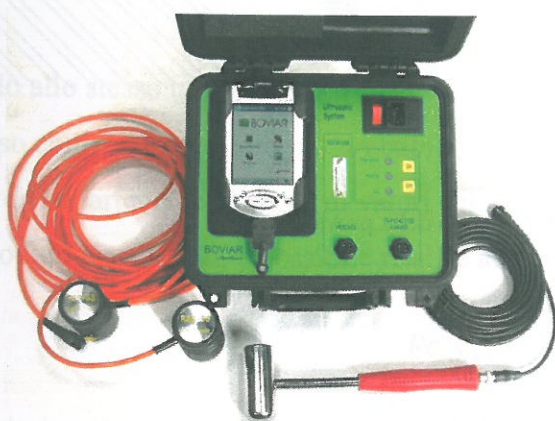
Apparecchiatura ultrasonica SOLGEO CMS , tipico segnale di acquisizione
