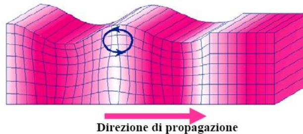
Fig. 1 - Rappresentazione grafica della propagazione delle onde superficiali di Rayleigh caratterizzata dall'oscillazione polarizzata in un piano verticale e con movimento delle particelle retrogrado rispetto alla direzione di propagazione dell'onda.
