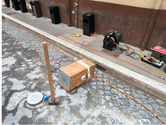
Fig. 3 – Sistema di energizzazione
