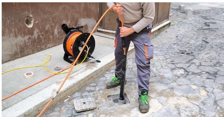
Fig. 2 - Sensore sismico quinquassiale da foro BGK5 ( Geotomographie )
