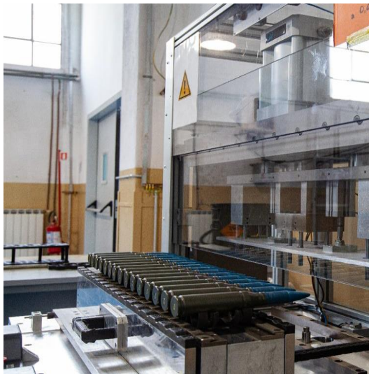
Figura 3 - Dettaglio dell'isola robotizzata per la rilavorazione di munizioni cal. 25x137
