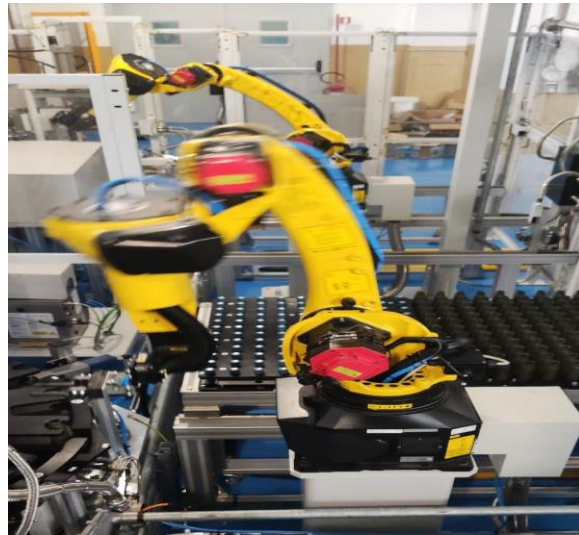
Figura 3 - Dettaglio dell'isola robotizzata per la rilavorazione di munizioni cal. 25x137
