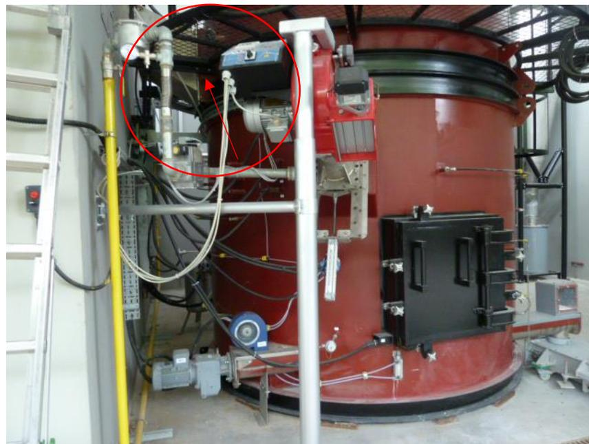
Figura 6 – Forno statico (in evidenza la zona dello scivolo)
