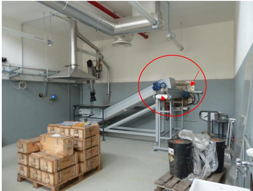
Figura 5 – Sala di carico (in evidenza saracinesca di sicurezza e nastro inseritore)
