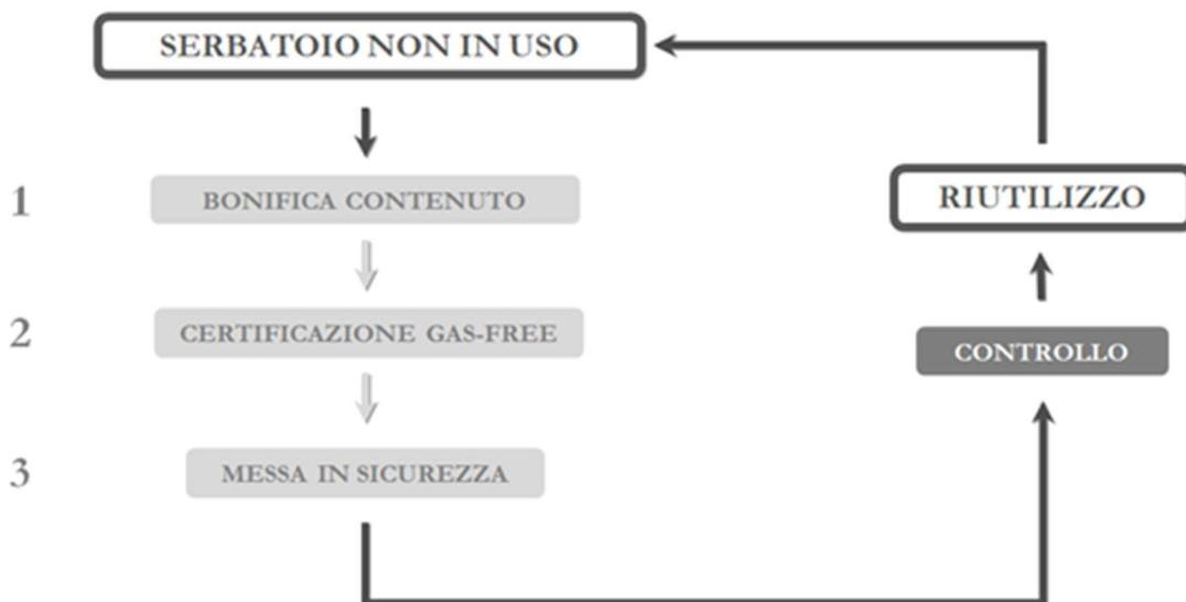
Fig.8) Diagramma riassuntivo delle principali azioni da intraprendere in materia di serbatoi interrati non in uso.
