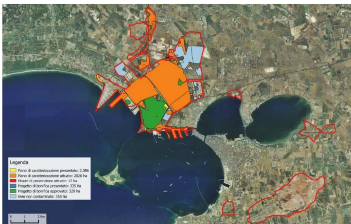
Figura 33 – Stato delle procedure di bonifica dei terreni giugno 2020 (giallo: piano di caratterizzazione presentato; arancione: piano di caratterizzazione attuato; rosso: misure di prevenzione attuate; blu: progetto di bonifica presentato; verde: progetto di bonifica approvato; azzurro: aree non contaminate)
