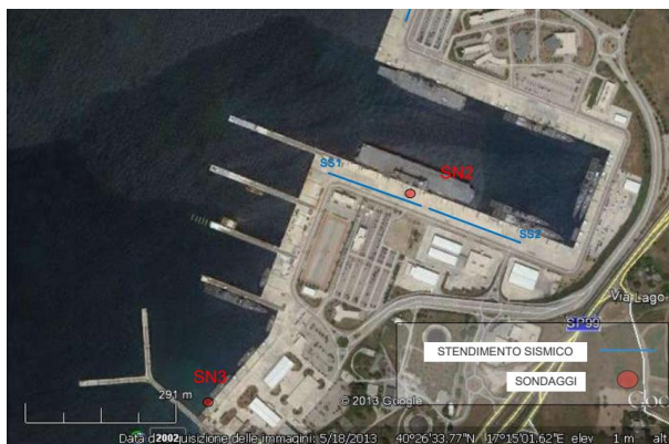
Figura 8.1 - Sondaggio SN3 alla radice del Chiapparo (da Studio di Fattibilità)
