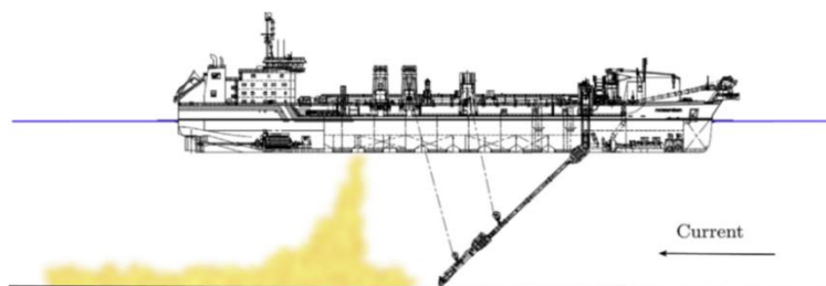
Fig. 8.66 - Draga aspirante-refluente autocaricante (TSHD; Becker et al., 2015)
