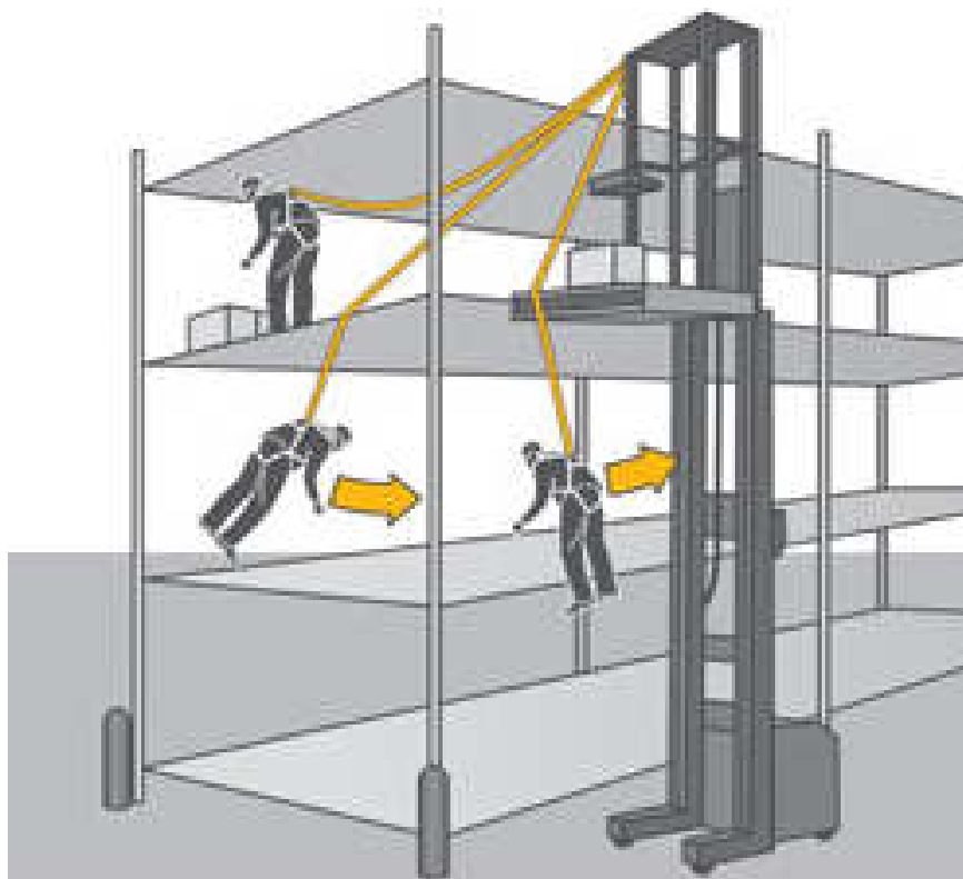
28. Rischi di collisione dovuti all'effetto pendolo
