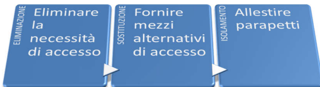
27. Schema di applicazione delle misure di protezione anticaduta collettive
