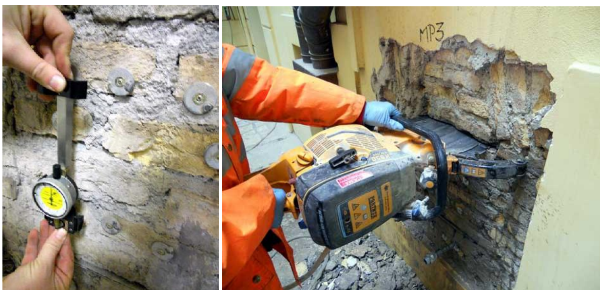
figg. 3.1 e 3.2 – Misura distanza originaria (prima del taglio) tra le basi e taglio per alloggiare il martinetto
