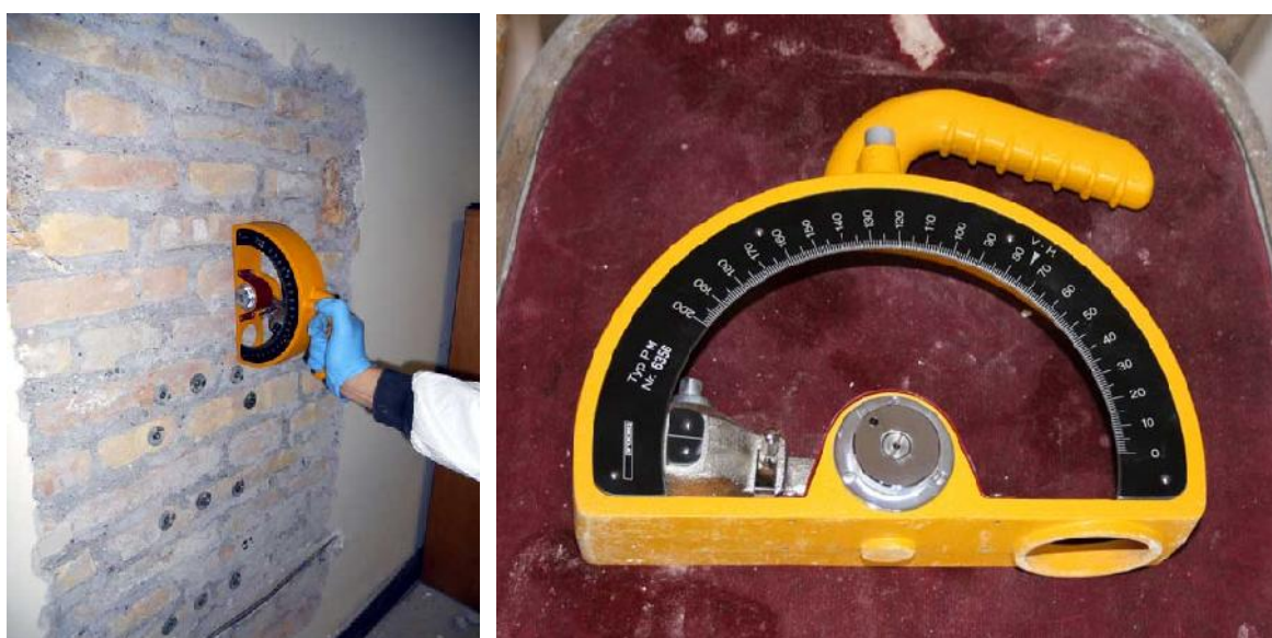
figg. 4.1 e 4.2 – Sclerometro per malte
