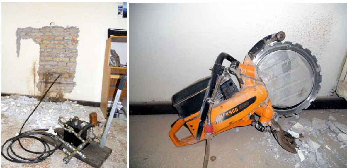
figg. 3.10 e 3.11- Pompa con manometro e sega circolare
