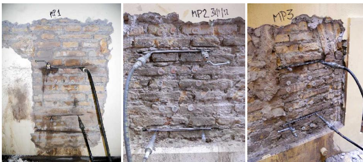
figg. 3.6, 3.7 e 3.8 – Prove con martinetto doppio MP1, MP2 e MP3
