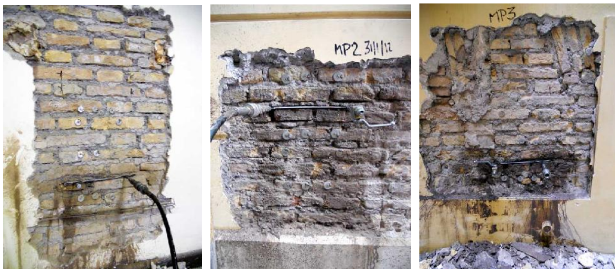
figg. 3.3, 3.4 e 3.5 - Prove con martinetto singolo MP1, MP2 e MP3
