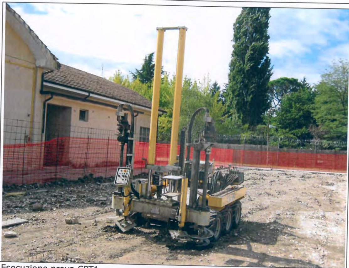
Esecuzione prova CPT1
