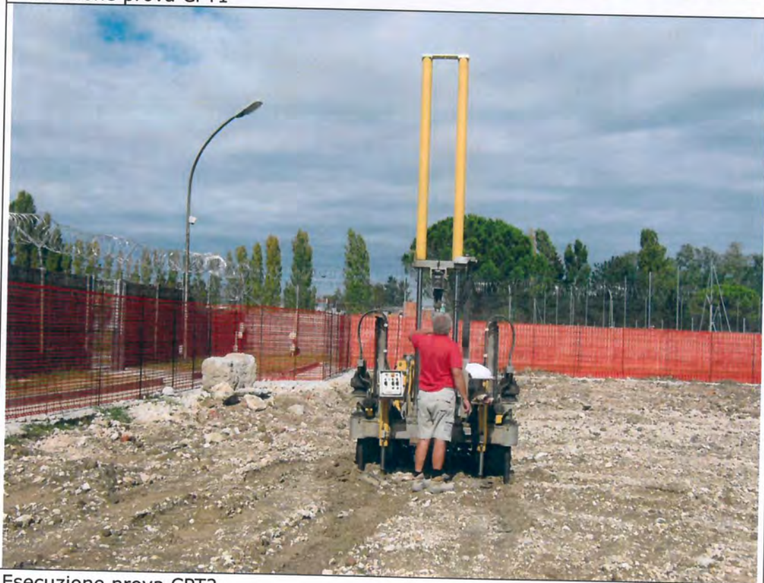
Esecuzione prova CPT2
