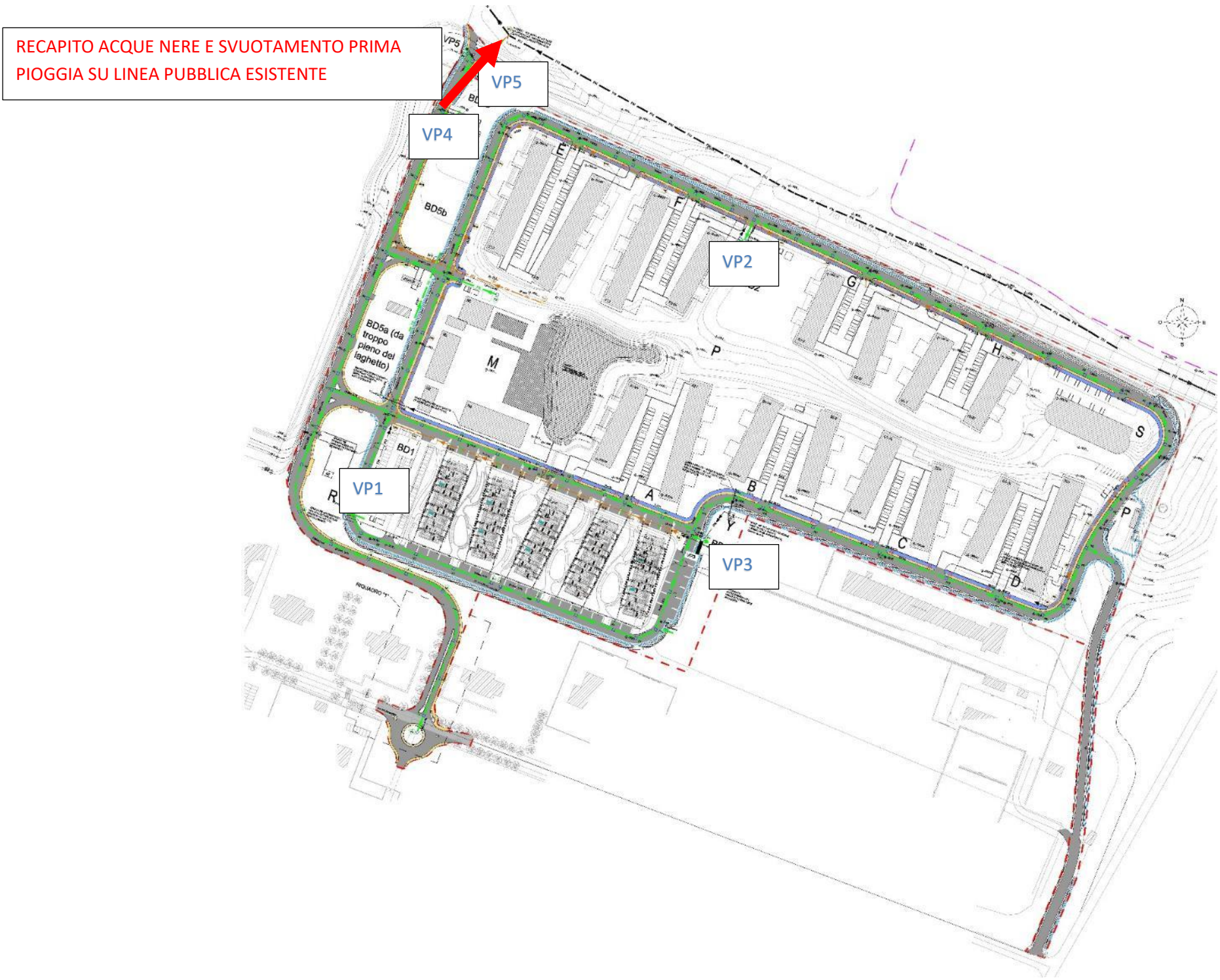
Figura 5 Planimetria generale fognature di progetto con posizione schematica impianti prima pioggia
