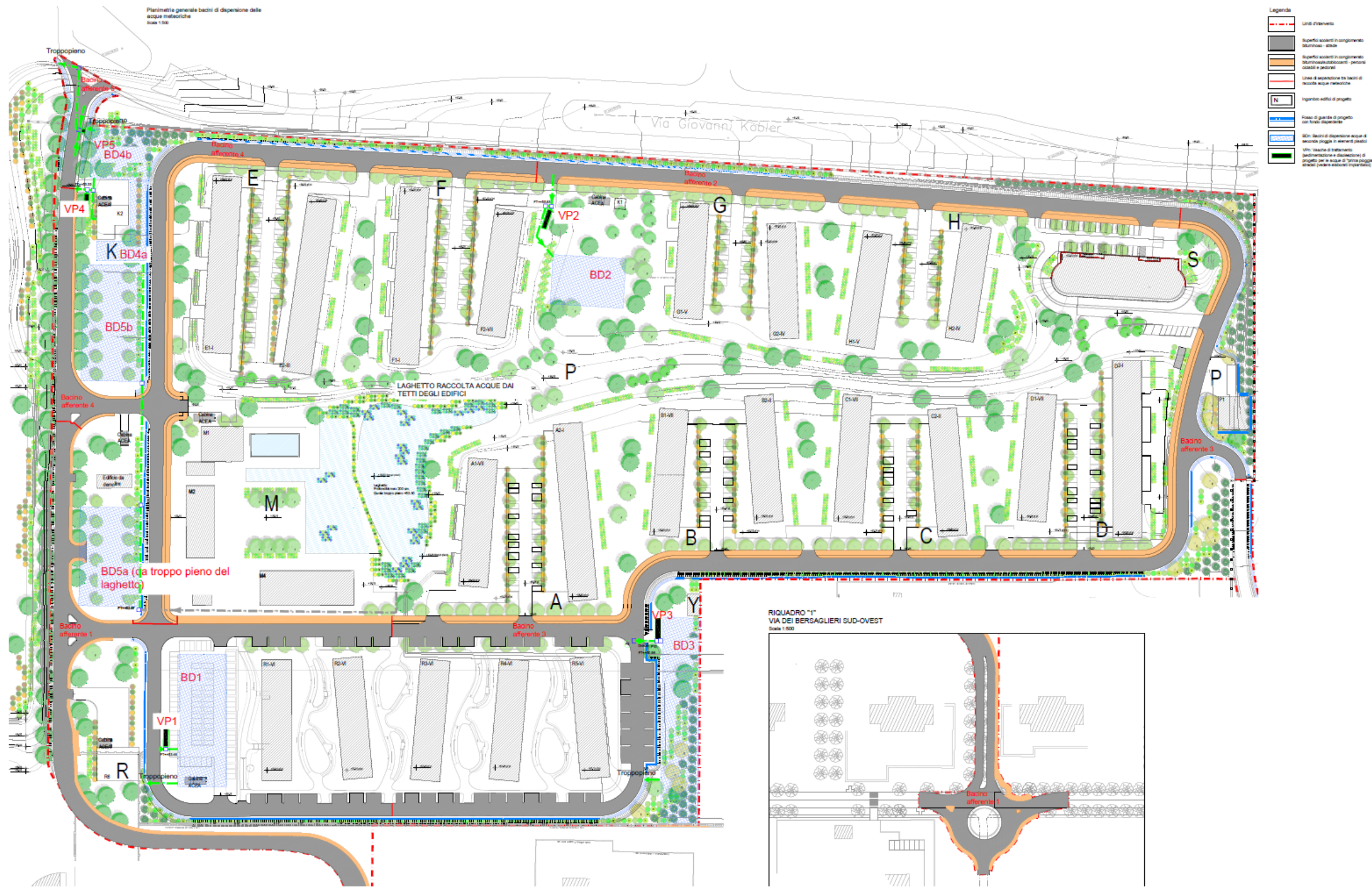
Figura 6 Schema generale suddivisione bacini di contribuzione e bacini di dispersione acque meteoriche
