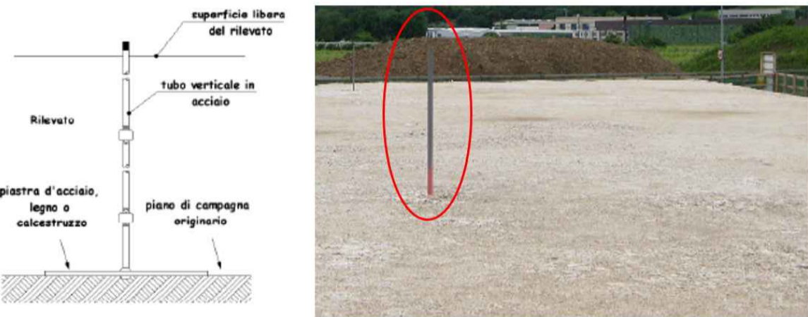
Esempio di rilevato di precarica e assestimetri a piastra
