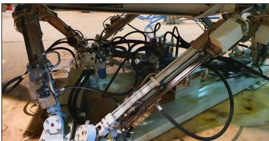
Figura n.2 – sistema idraulico simulatori *motion* UH-205A
