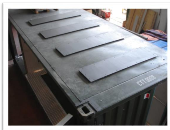
Fig. 3 Immagini esemplificative, Tetto indebolito – vista esterna
