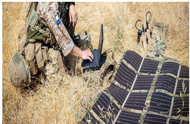
Fig. 27 – Modulo solare portatile e pieghevole per usi tattici Fonte: Royal United Services Institute (2022)
