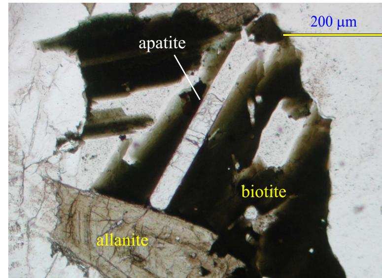
Fig. 8.2. Immagini al microscopio di polarizzazione di fasi mineralogiche portatrici di uranio in leucograniti della Sardegna.
