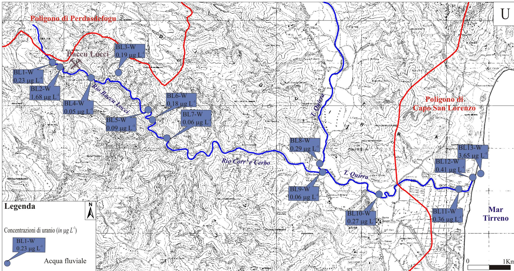
Fig. 10.6. Concentrazioni di uranio nei campioni di acqua fluviale prelevati nel sistema idrografico Rio Baccu Locci - Rio Corr' e Cerbo - T. Quirra.
