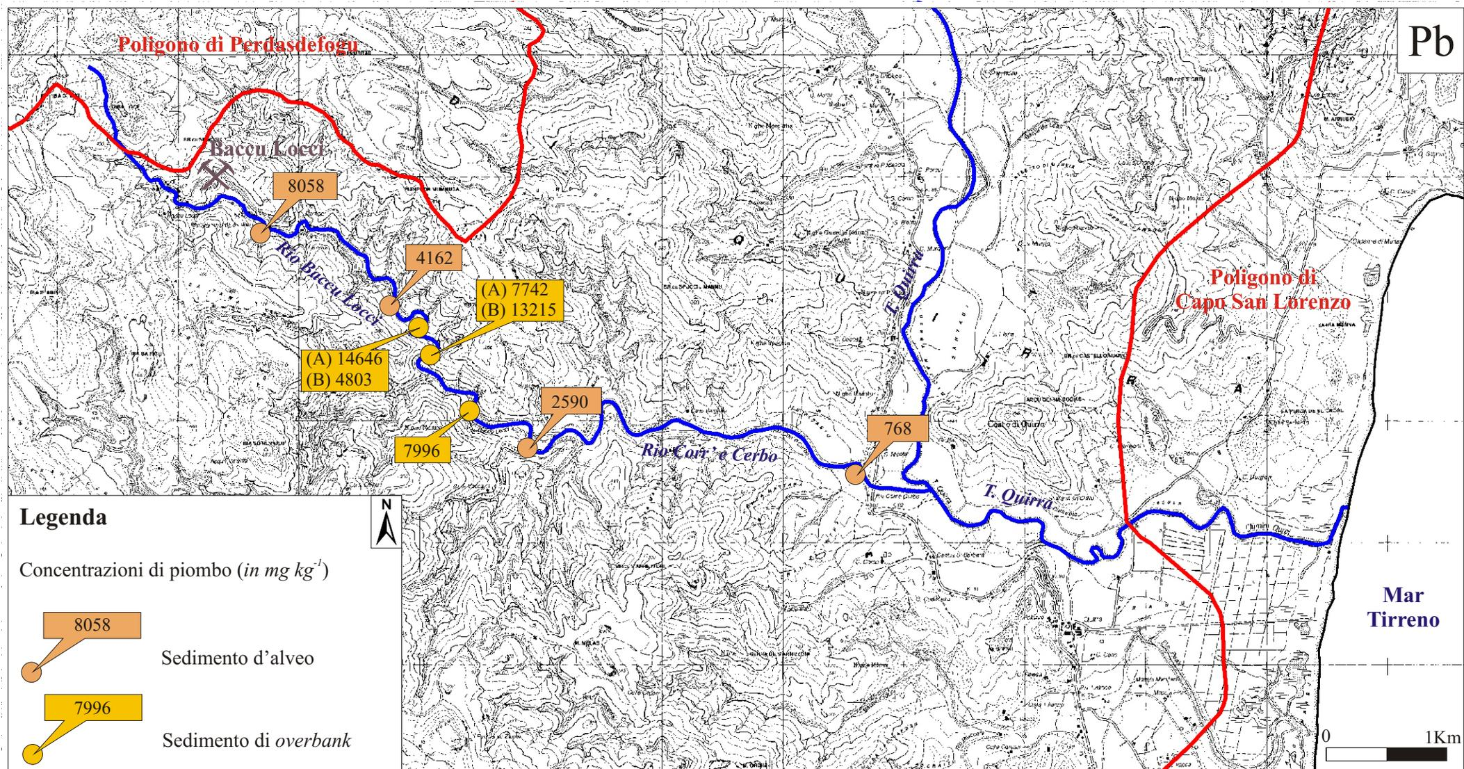
Fig. 11.5. Concentrazioni di piombo nei campioni di sedimento fluviale prelevati nel sistema idrografico Rio Baccu Locci - Rio Corr'e Cerbo.
