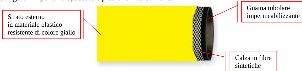
Figura 1: Spaccato di una tubazione.
