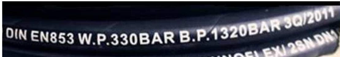
Figura 4 Esempio di marchiatura sul tubo in gomma
