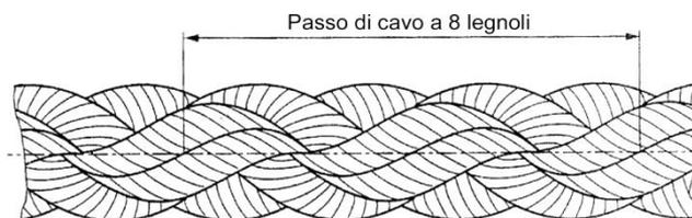
FIGURA 25 – lunghezza del passo del cavo a 8 legnoli
