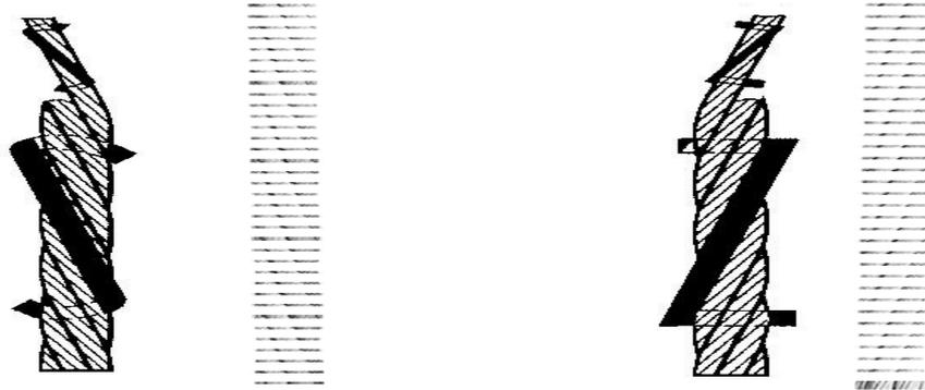
FIGURA 53 – Avvolgimento parallelo: Sinistro (sS) (a SX) e Destro (zZ) (a DX)
