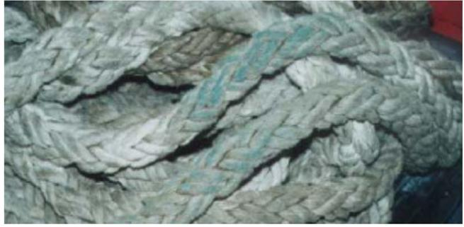
Cavo in manila che presenta gli effetti dovuti ad attacco da idrocarburi e rottura a trazione
