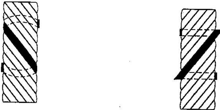
FIGURA 51 – Senso di avvolgimento del trefolo: S (a SX) e Z (a DX)
