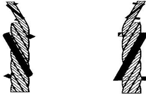
**FIGURA 17 – Avvolgimento parallelo: Sinistro (sS) (a SX) e Destro (zZ) (a DX)**
