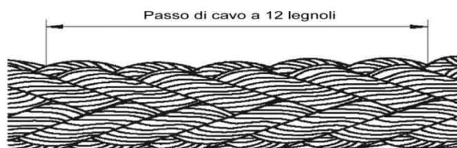
FIGURA 26 – lunghezza del passo del cavo a 12 legnoli
