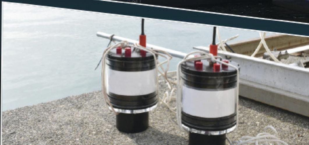
Il progetto ha l'obiettivo di realizzare sistemi di comunicazione acustica innovativi e reti di comunicazione subacquee integrate per veicoli autonomi. Tali sistemi di comunicazione sono modem acustici software-defined, impiegabili sia per comunicazione fra veicoli, sia per il tracciamento degli stessi.
