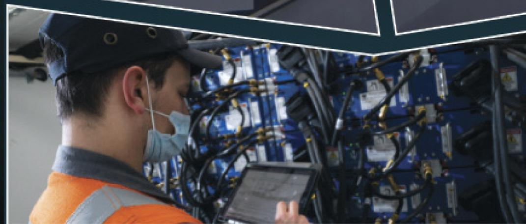
Ambiente di prova in scala reale per smart-grid in corrente continua. È stato progettato per validare il progetto di reti in corrente continua resilienti al danno e capaci di erogare energia in diverse condizioni applicative (resilient smart grid), con in particolare picchi di energia di diversi MW in pochi millisecondi (n.d.r. 2.5MW in 40ms per armi ad energia diretta e sensori ad alto assorbimento).
