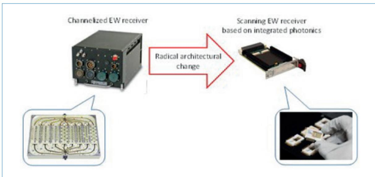
Figura 1 - Soluzione low SWaP necessaria per nuove piattaforme: Fighter 6<sup>th</sup> gen e UAV
