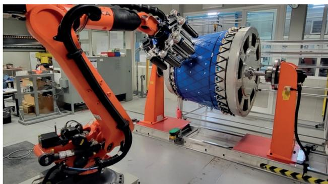
Nuova cella robotizzata per “avvolgimento parallelo” della preforma secca in fibra di carbonio
