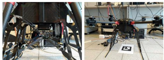
**Figura 4** - Intelligent Payload schierato a bordo di un drone multirotore
