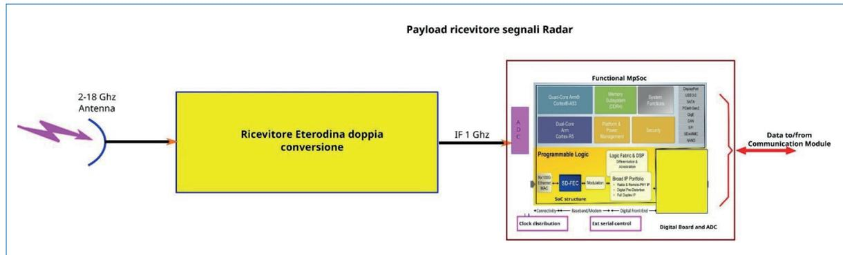
Figura 17 - Schema a blocchi complessivo del payload di ricezione segnali radar
