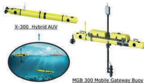
Figura 2 - Rappresentazione della vignetta con la cooperazione multi-veicolo, in cui si evince l'interazione tra un veicolo autonomo subacqueo, uno di superficie e l'Unità navale di appoggio.
