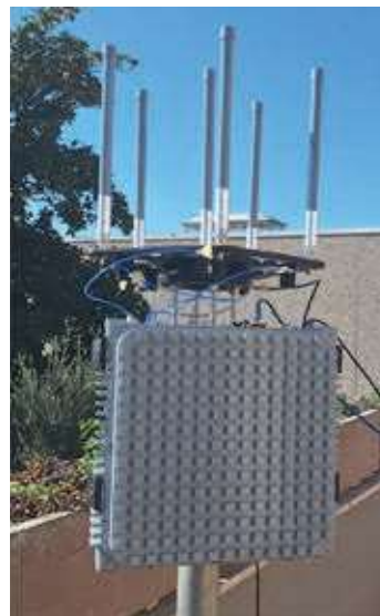
Figura 6 - Il sistema interferometrico (versione a 5 antenne). Il sistema sviluppato può essere configurato con un numero qualunque di antenne, comunque disposte.
