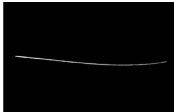
Figura 2 - Frame catturato durante i test di valutazione propulsiva della parte flessibile della coda tramite telecamera veloce.
