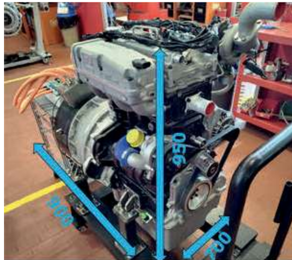
Figura 4 - Dimensioni complessive del gruppo ibrido 2CHDP.
