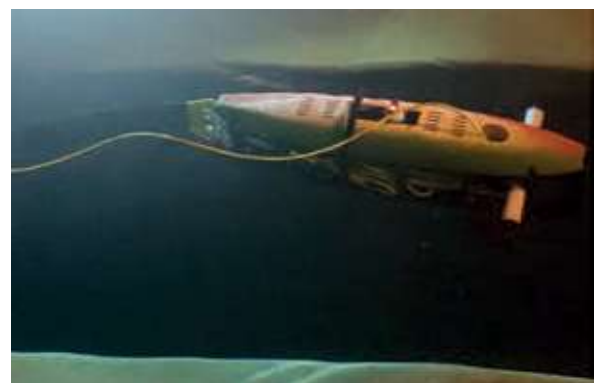
Figura 5 - Il prototipo di PERSICO durante le prove in vasca al CNR-INM Roma.
