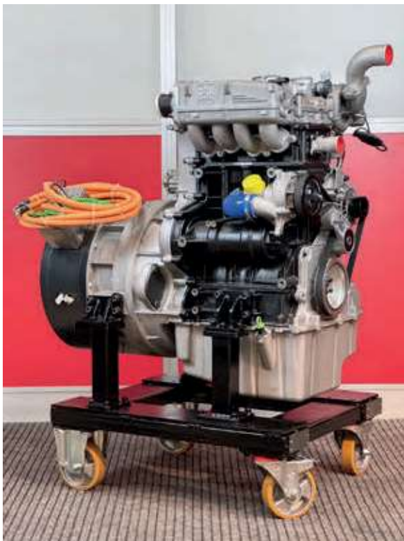
Figura 7 - Motore assemblato pronto per sala prova.
