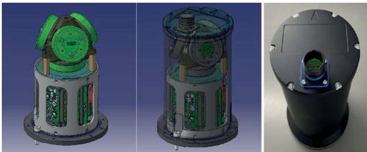
Figura 3 - Modello 3D-CAD e prototipo reale MRFOGINS.
