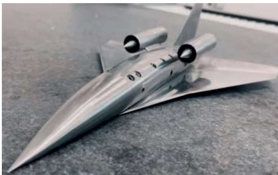
Figura 7 - Dimostratore#1 della configurazione di HYPERION. Modello in scala 1:72 per prove in galleria del vento in regime subsonico, transonico e supersonico.
