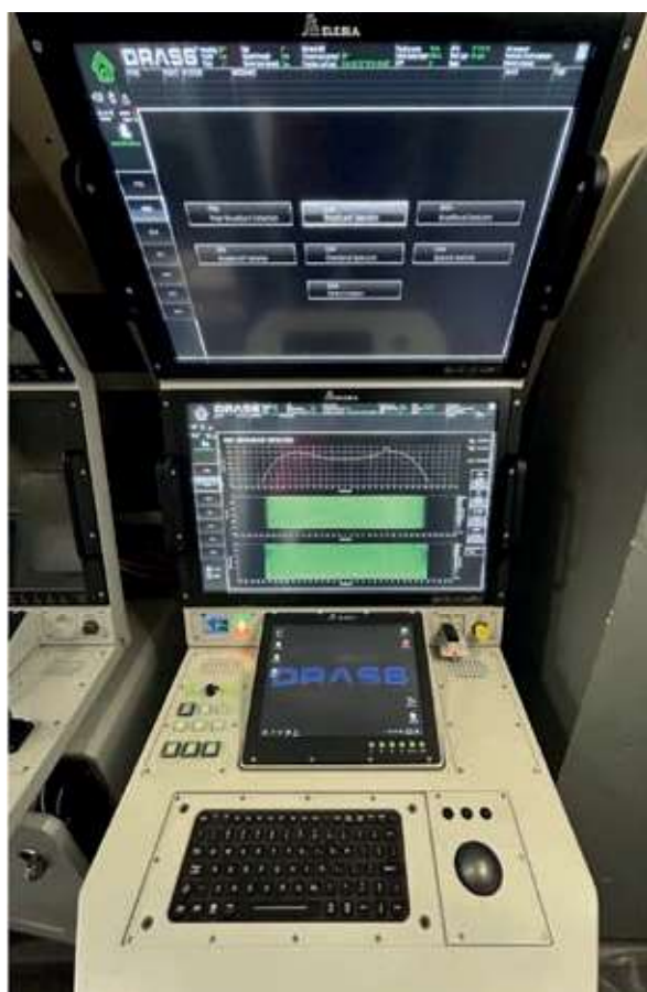
Figura 4 - Interfaccia utente per l'analisi del segnale sonar passivo su console DRASS.
