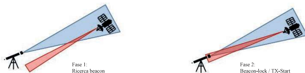
Figura 1 - Descrizione funzionale della sequenza di Puntamento, Acquisizione e tracking: la stazione di terra segue il satellite, di cui conosce i dati orbitali, con una logica di puntamento programmato e inizia a trasmettere una portante non modulata. Il satellite punterà il centro del fascio ricevuto e inizierà a trasmettere il proprio segnale modulato. I terminali terranno conto del tempo di propagazione per un corretto inseguimento.
