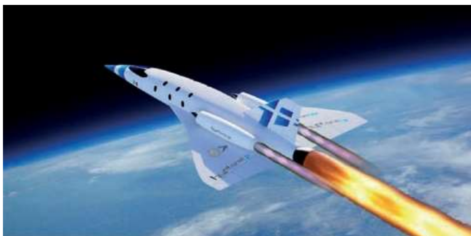
Figura 2 - HYPLANE HYpersonic SpacePLANE. L’ampia superficie alare ha il vantaggio di consentire decolli e atterraggi a bassa velocità (60 m/s) e quindi lo spaziplano può decollare ed atterrare orizzontalmente (HTHL) su piste di breve-media lunghezza (<1.000 m).
