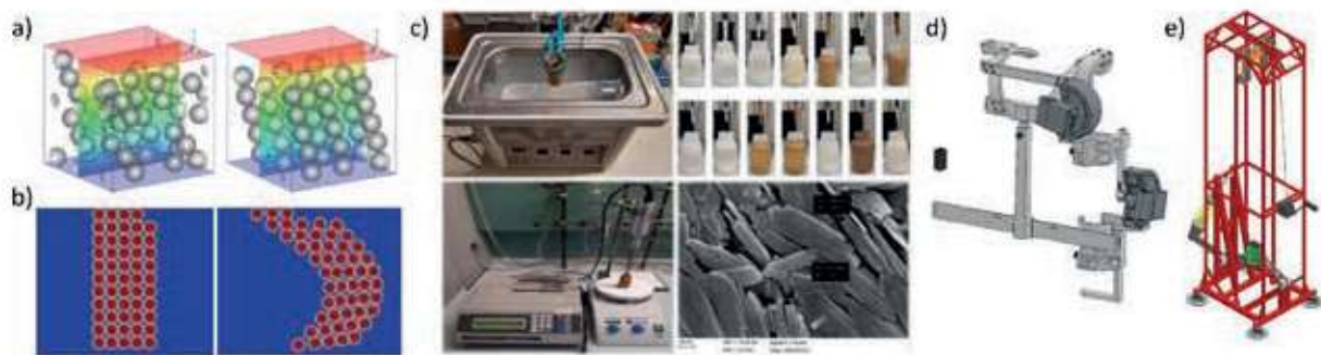
Figura 1 - (a-b) Esempio di modellizzazione di (a) ERF e (b) MRF. (c) Sintesi e prototipazione di nanoparticelle e fluidi. (d-e) Progettazione esecutiva di dimostratori basati su (d) ERF e (e) MRF. / (a-b) Modeling example of (a) ERFs and (b) MRFs. (c) Nanoparticles synthesis and fluid prototyping. (d-e) Executive design of (d) ERF-based and (e) MRF-based demonstrator.
