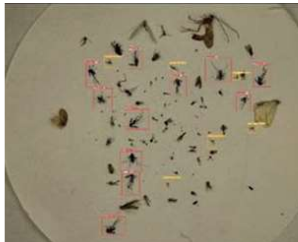
Figura 2A - L'algoritmo di intelligenza artificiale dopo il processo di "e-learning" analizza l'immagine acquisita e genera il risultato mostrando gli esemplari rilevati, evidenziati e classificati.
