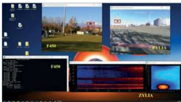
Figura 6 - Visualizzazione dei flussi A/V e del controllo sullo schermo della stazione di terra dopo la rivelazione audio.
