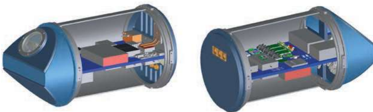
Figura 2 - Rendering del trasmettitore del sistema QKD progettato durante questa fase del progetto / Rendering of the QKD system transmitter designed during this phase of the project.
