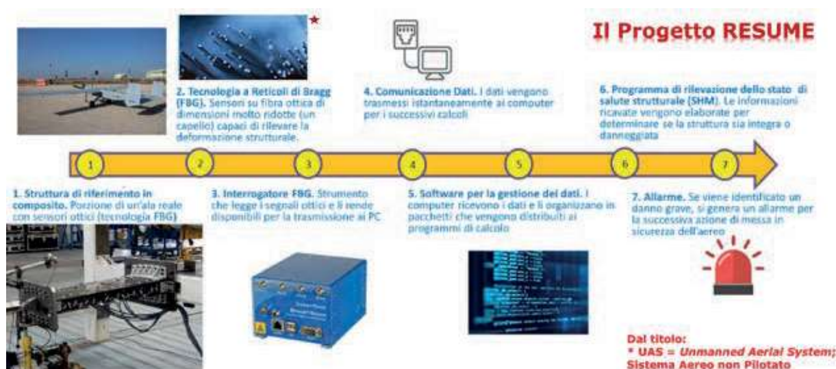
Figura 1 - Architettura e logica del sistema SHM concepito all'interno del progetto RESUME. 1. Struttura di riferimento disponibile presso gli stabilimenti di Piaggio Aerospace e rappresentante una sezione in scala reale di un wing-box alare; 2. Una rappresentazione pittorica dei reticoli di Bragg e delle fibre ottiche; 3. Uno degli interrogatori usati nel progetto, Smart Scan II, capace di tradurre il segnale ottico in valore di deformazione; 4. Schema logico di comunicazione dei dati dall'interrogatore al PC; 5. SW di gestione ed organizzazione dei dati, capace di garantire un flusso continuo di dati ai 6. SW di elaborazione, in grado di identificare la presenza di un danneggiamento strutturale sulla base delle anomalie registrate; 7. Feedback del sistema all'operatore, gestito da un pacchetto dello stesso SW di gestione ed organizzazione dei dati, cui è demandata la decisione di intervento sul sistema aereo.
