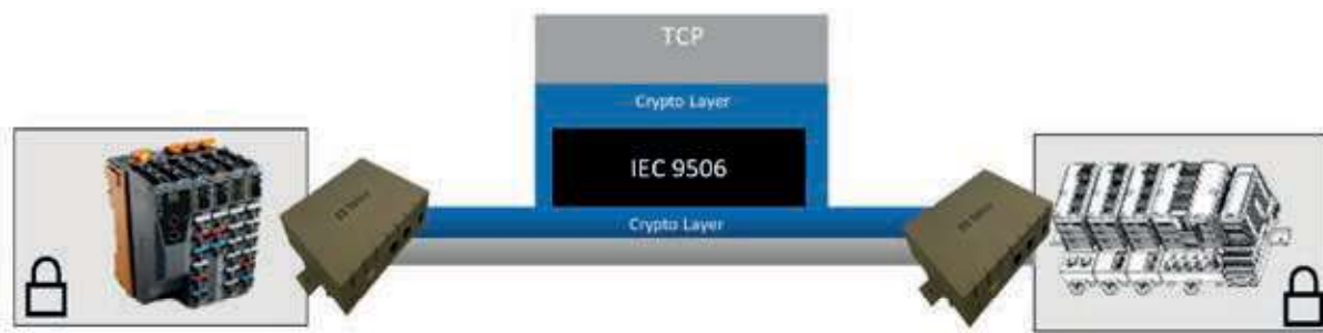
Figura 1 - Layer crittografico e compatibilità con i protocolli industriali / Cryptographic layer and compatibility with industrial protocols.
