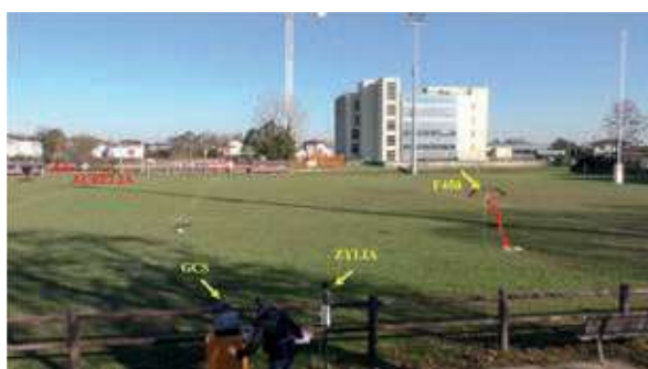
Figura 5 - Detection audio (con sensore Zylia) con soglia di energia acustica e misura di angolo.
