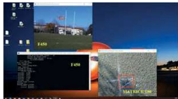
Figura 4 - Visualizzazione dei flussi video e del controllo sullo schermo della stazione di terra dopo la rivelazione video.
