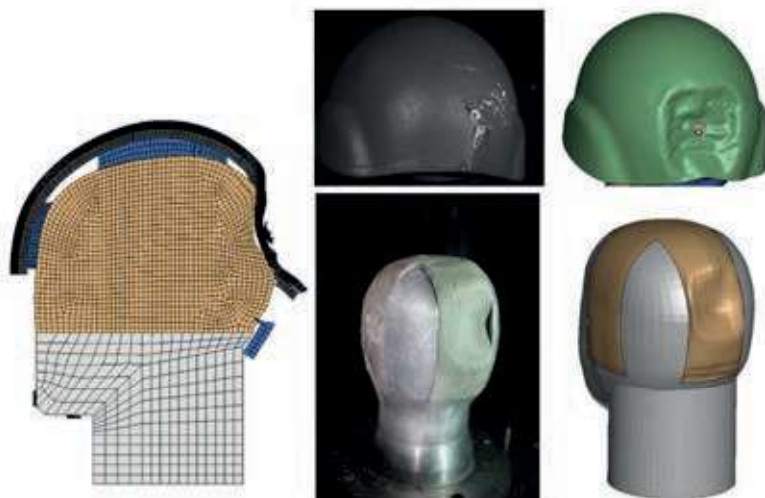
Figura 2 - Comparazione numerico sperimentale di un impatto occipitale, Cal 9x19 FMJ (7.45g) - 390 m/s; la misura del trauma sperimentale (16 mm) e numerico (15 mm) mostrano un'ottima concordanza.
