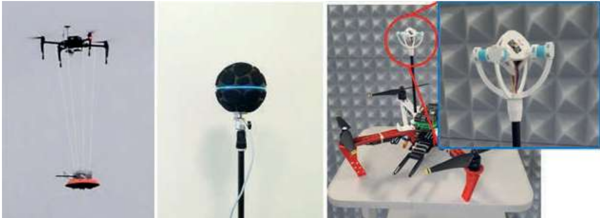
Figura 2 - Sensori audio: array circolare (sinistra), array sferico Zylia (centro), array tetraedrico Ambisonic (destra).
