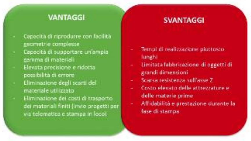
Fig. 5 - Vantaggi e svantaggi della metodica con stampa 3D, rispetto alla produzione tradizionale, di un dispositivo ortopedico.
