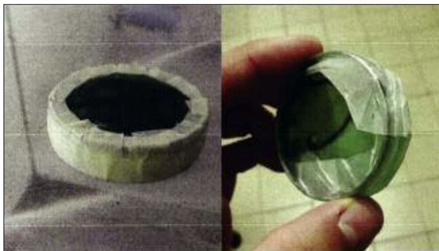
Fig. 2 - Sistema di feeding basato su una miscela di idrossi-etil-cellulosa, miele e blu di metilene.
