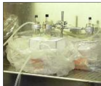
Fig. 5 - Infezioni sperimentali. Sistema di Membrane-feeding.
