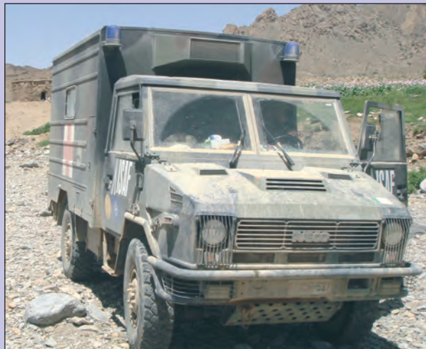
Ambulanza italiana VM 90 in Afghanistan. Le comunicazioni radio non sono state previste per questo mezzo. Alcune sono state temporaneamente dotate di sistemi di comunicazioni radio HF 178 veicolari.
