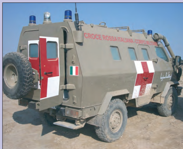
VM 90 Protetto ambulanza tipo A del Corpo Militare della Croce Rossa Italiana. È dotato di un potente sistema radio HF e VHF commerciale.
