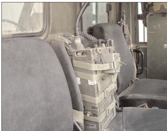
Montaggio di fortuna "a sedile" di una radio Sincars VHF in versione portatile. Soluzione necessaria per restare costantemente in contatto con tutta la colonna durante le pattuglie.
