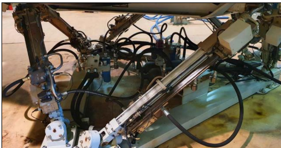
Figura 2 – Sistema idraulico allenatori motion UH-205A
