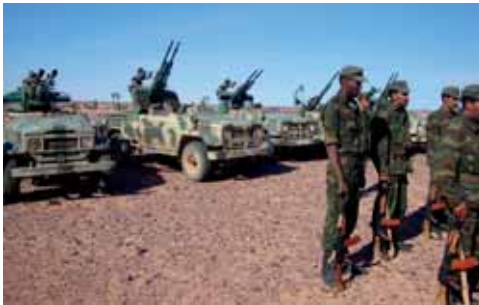
Le unità motorizzate dell'ELPS sono impennate su veicoli Toyota 4x4 armati di mitragliere ZU-23 (23 mm). Nella foto, alcuni di questi veicoli.
