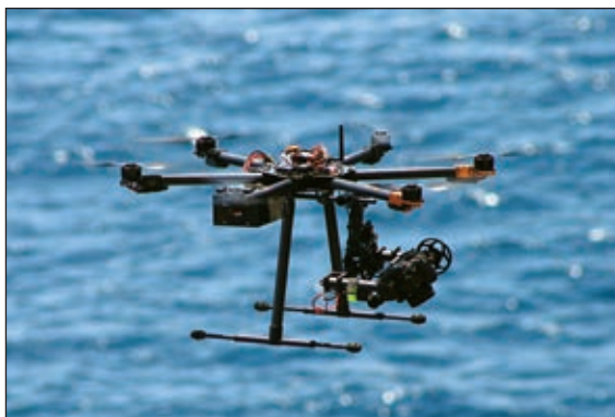
Attività di rilievi topografici con droni - by Idrogeo
