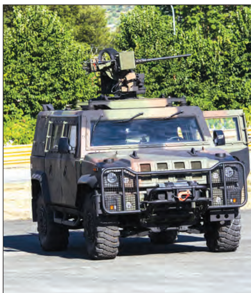
Le nuove soluzioni tecniche esaltano e ridefiniscono il ruolo operativo di veicoli e sistemi d'arma (nella foto: VTLM "Lince" con torretta HITROLE LIGHT – cortesia di OTO MELARA)
